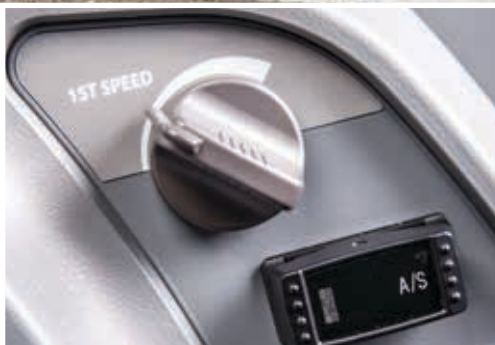
El dial de velocidad en primera mejora el rendimiento en diferentes zonas de trabajo.
