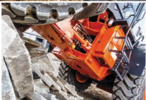
El protector inferior opcional ofrece una protección añadida.
