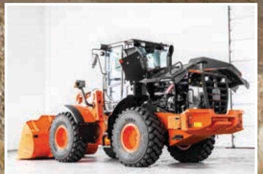
Acceso sencillo a nivel del suelo para realizar tareas de mantenimiento.
