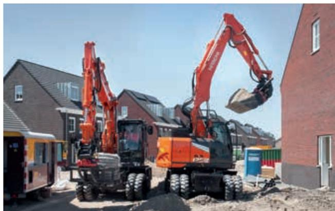
La ZX135W-7 gira con un radio de 3,5 metros (1.740 mm por la parte trasera y 1.750 mm por la parte delantera).
