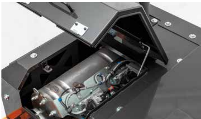
Los intervalos de servicio para el filtro CSF se han incrementado de 4.000 a 6.500 horas.
