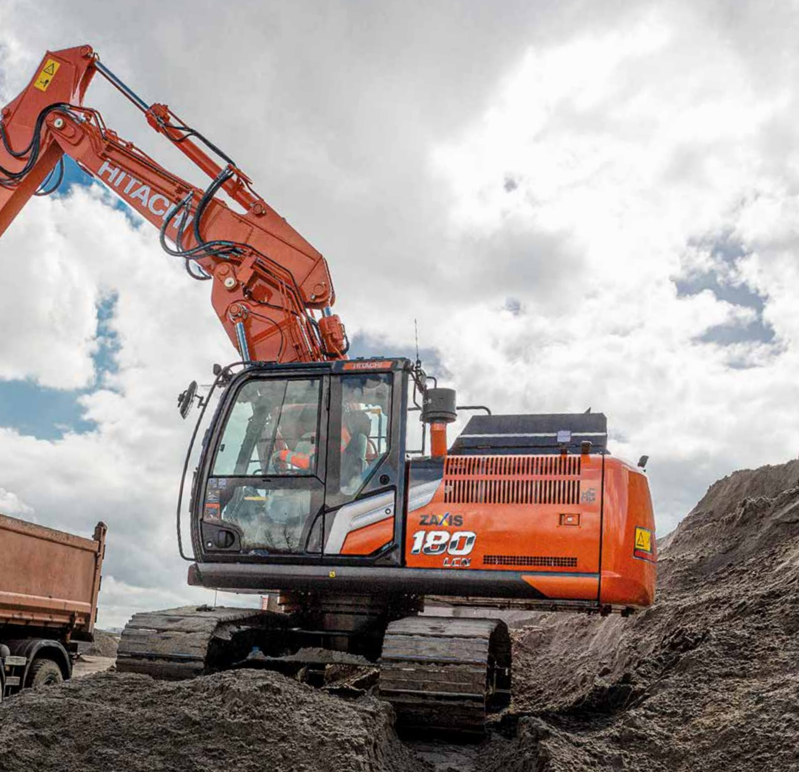
El sistema hidráulico HIOS IV reduce el consumo de combustible mientras mantiene la productividad.
