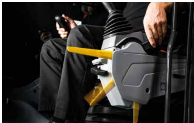
La palanca de corte de pilotaje ofrece mayor seguridad en la cabina.
