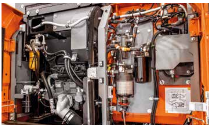
Los filtros se han recolocado para facilitar el acceso.
