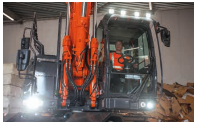
Las luces de trabajo LED mejoran la visibilidad en condiciones exigentes.
