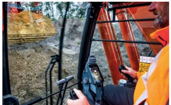
El diseño ampliado del limpiaparabrisas proporciona una mayor visibilidad.
