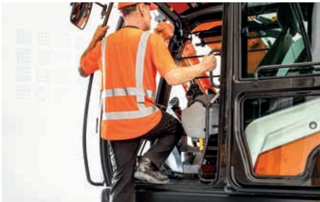
La cabina de la ZX225US-7 y ZX225USR-7 tiene un interior más grande y una apertura de puerta más ancha para facilitar el acceso.
