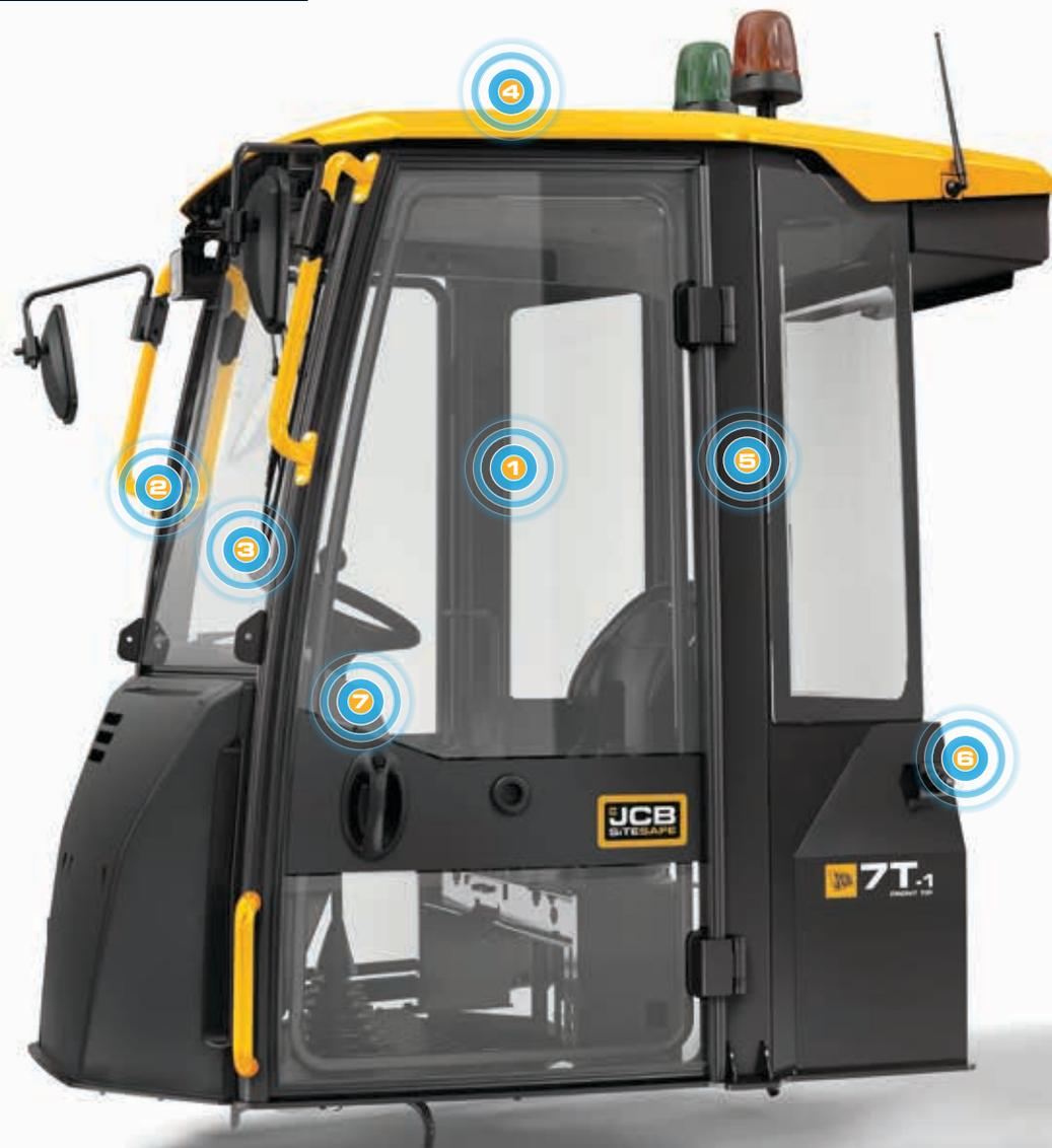
1. El cristal plano permite su sustitución rápida y reduce su coste.
