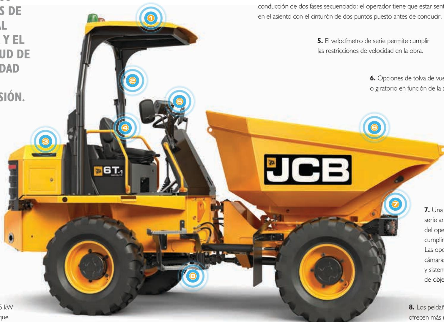
**4.** La seguridad está garantizada gracias al sistema de inhibición de la conducción de dos fases secuenciado: el operador tiene que estar sentado en el asiento con el cinturón de dos puntos puesto antes de conducir.
