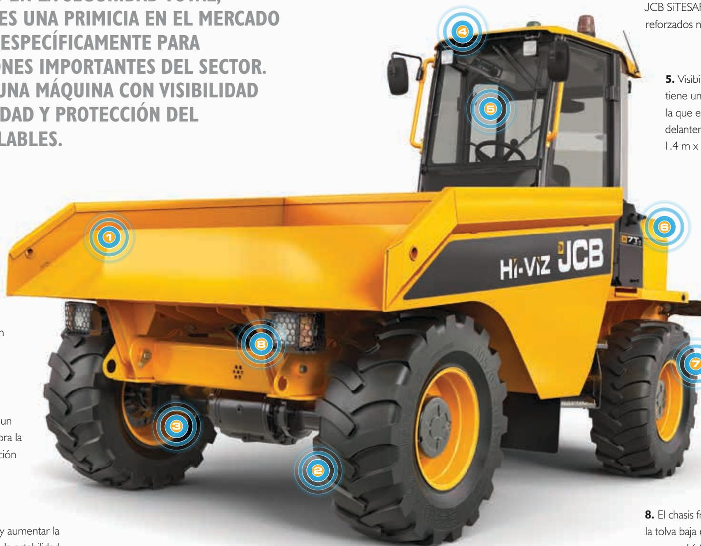
**4.** ROPS/FOPS nivel II con cabina de protección JCB SiTESAFE de serie. El bastidor y el cristal reforzados mantienen seguro al operador.
