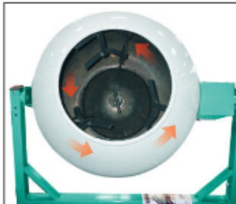
El sistema de mezcla Imer se reconoce por diferentes aspectos: el tipo de cuba de fondo ancho con contrafondo, la geometría particular de sus palas de mezcla y el bajo número de giros de la cuba. El material mezclado resulta muy homogéneo y compacto.
