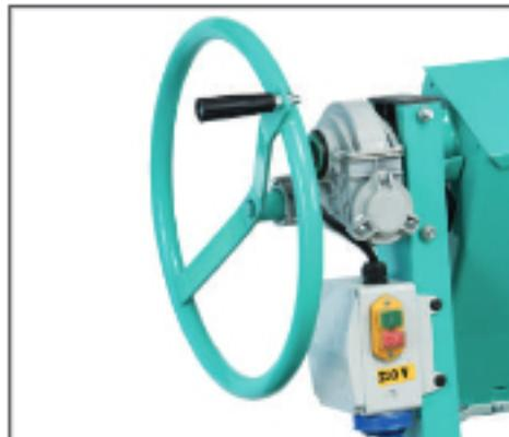
Gracias a su volante de tipo alerón, reduce al máximo el esfuerzo personal del operario en su basculación, permitiendo a su vez este sistema posicionar la cuba de amasado con la inclinación exacta y precisa.
