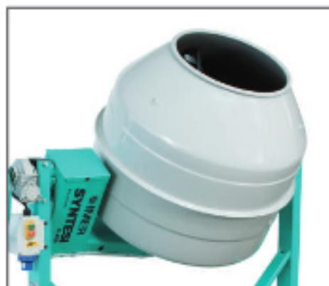
Al eliminar sobre las hormigoneras tradicionales los principales componentes mecánicos: corona de rotación de la cuba, plíón de ataque a la corona, polea motriz y carcasa de basculación con volante mediante registros, ésta ofrece la máxima seguridad para el operario y el mínimo mantenimiento. La ausencia de engranajes mecánicos externos, reduce su rumorosidad hasta 72 dB(A). Se ve girar la cuba pero no se la oye.
