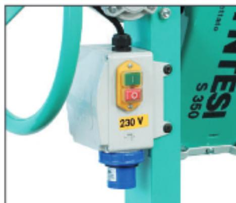
Todos los modelos con motor eléctrico están equipados con interruptores con protección IP 65 con bobina. La protección térmica protege el motor de las sobrecargas; la bobina impide la puesta en marcha involuntaria de la máquina después de una pérdida de tensión.
