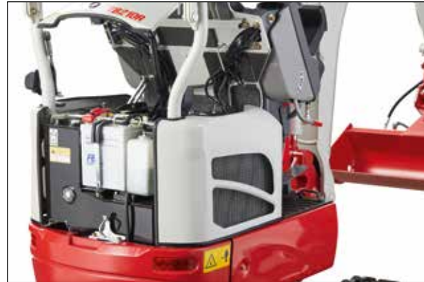
Amplia tapa de mantenimiento para facilitar el acceso al motor y los componentes hidráulicos.
