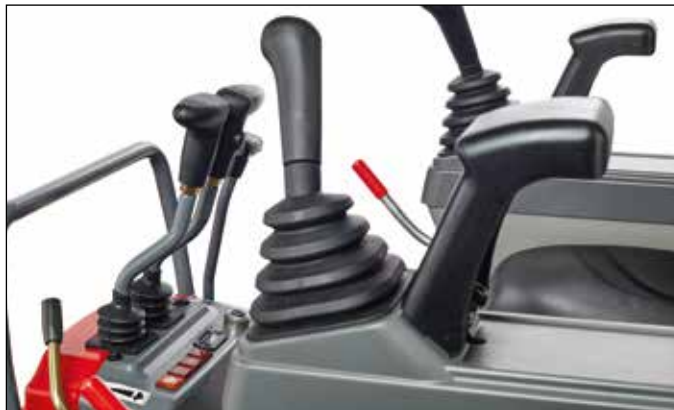
Los servomandos colocados de manera óptima en combinación con los apoyabrazos garantizan un trabajo preciso y seguro.
