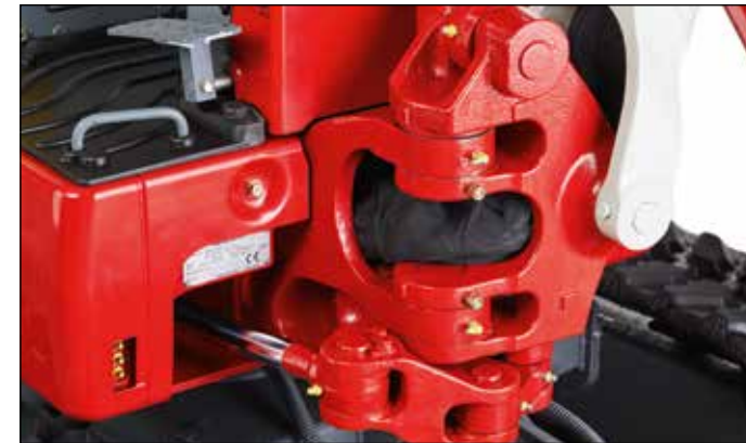
Bloque de giro robusto con cilindro de giro. Cilindro de elevación con amortiguación en el final de carrera.
