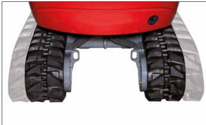
Tren de rodaje con anchura de vía hidráulicamente variable.
